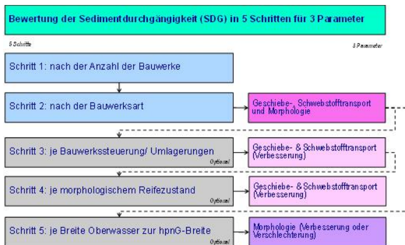
Abbildung 2-4: Vorgehen bei der LAWA-Methodik zur Bewertung der Sedimentdurchgängigkeit, Grafikquelle: https://www.mikepoweredbydhi.com/presences/emea/germany/news/2016/08/22/lawa-sedimente , Abruf am 22.02.2020
