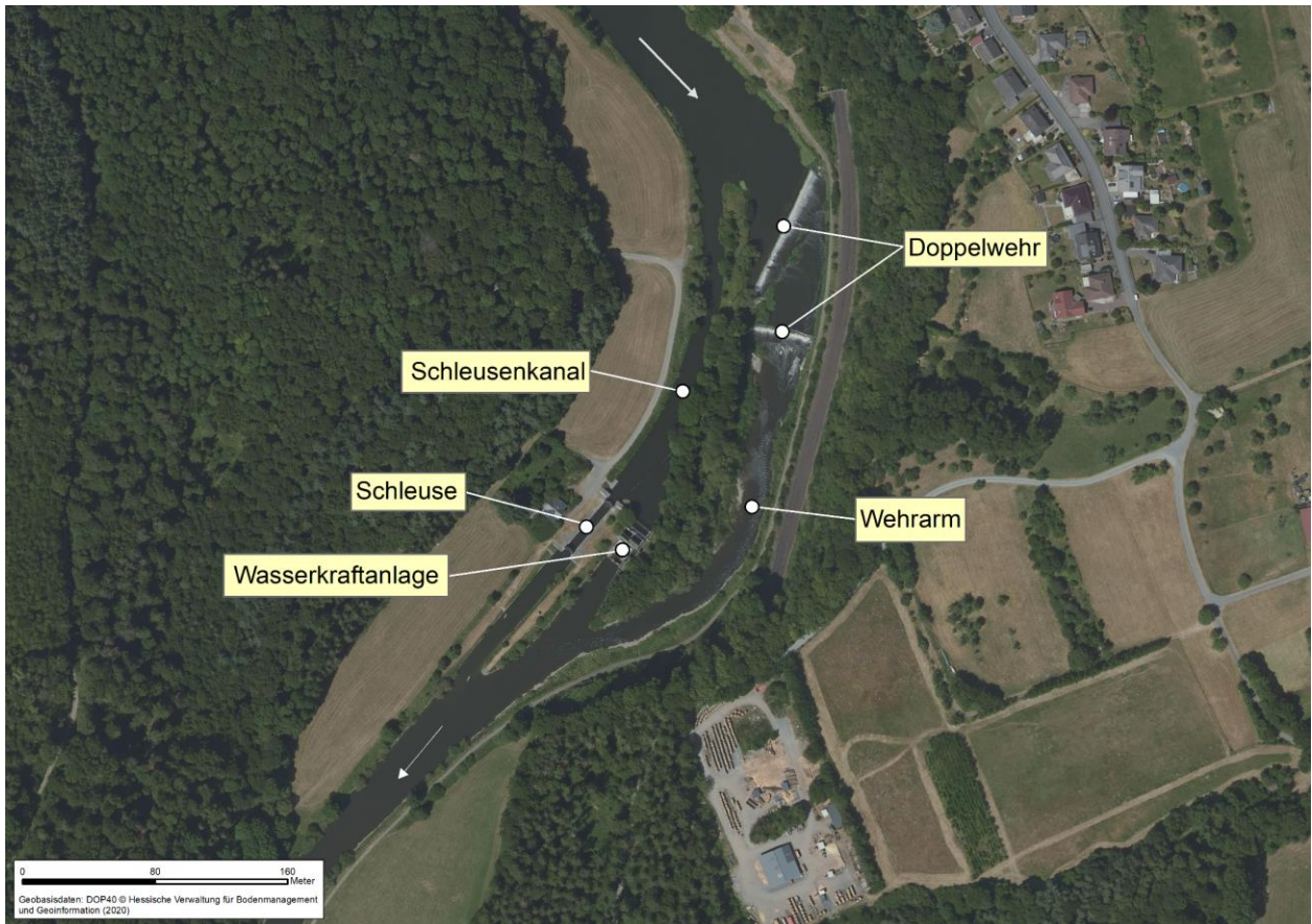
Abbildung 4-5: Staustufe Kirschhofen mit Wehr- und Schleusenanlage
