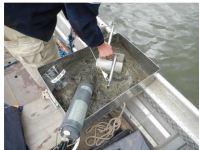
Probenahme mit Van Veen Greifer – Bild: BfG
