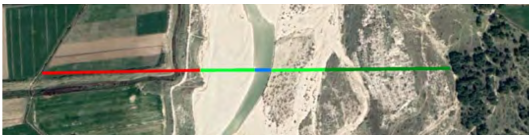
Abbildung 2 – Schematischer Querschnitt (oben) und Beispiel (unten) des hochwassergefährdeten Bereichs einschließlich Teilen des Gerinnes bei niedriger Wasserführung (blau), des bordvollen Gerinnes, das nur gewässert wird, wenn der Abfluss die niedrige Wasserführung übersteigt (Übergangszone; hellgrün) und der rezenten Aue (aktive Überschwemmungsfläche, dunkelgrün) und der Altaue (ehemalige Überschwemmungsfläche, rot) (Globevnik et al. , 2020).
