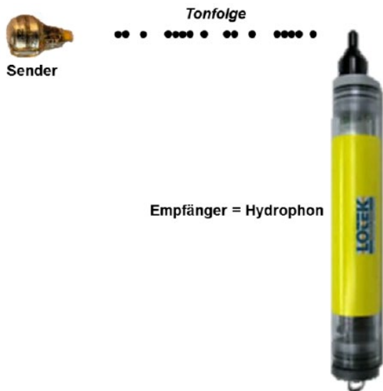
Abb. 4: Funktionsprinzip der akustischen Telemetrie - ein telemetrischer Sender sendet eine für jeden Aal individuelle Tonfolge aus, die vom Hydrophon zeit- und positionsgenau geortet wird (Grafik: Institut für angewandte Ökologie)
