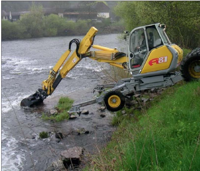
**Abbildung 3-11:** Unterhaltungsarbeiten des Außenbezirkes Wetzlar mit dem Schreitbagger „Menzi-Muck“ [60]
