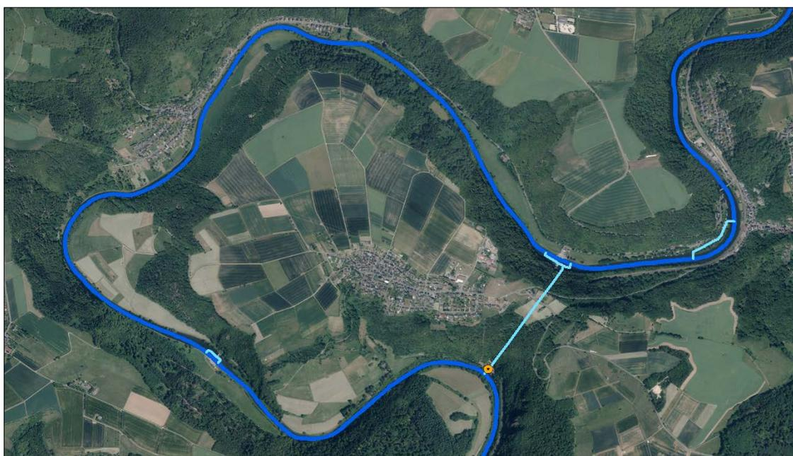
**Abbildung 2-11:** Luftbild der Lahnschleife bei Cramberg/Scheidt mit Darstellung des unterirdischen Kraftwerkskanals zur WKA Cramberg (Quelle: siehe Quellenverzeichnis Lahn-GIS)
