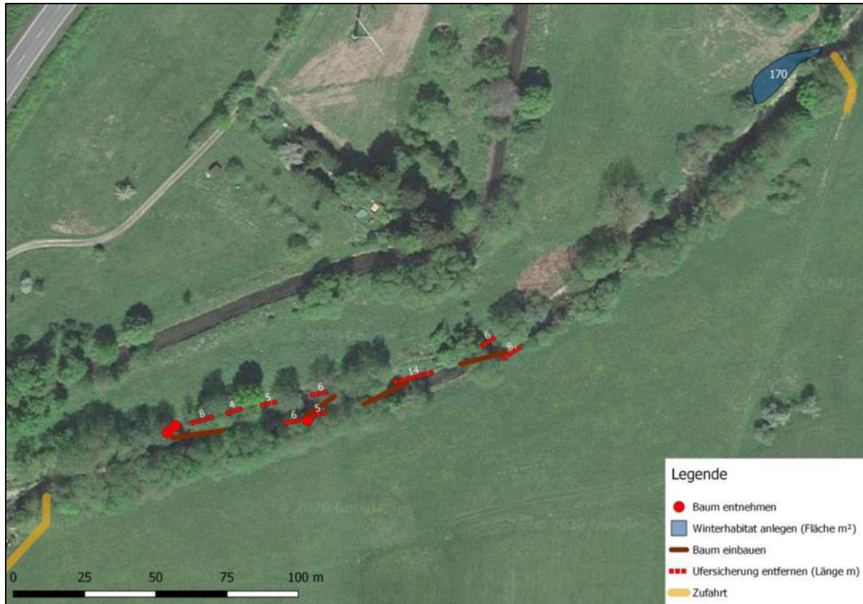
Abb. 2: Geplante Strukturierungsmaßnahmen unterhalb des Wehres Bohne.
