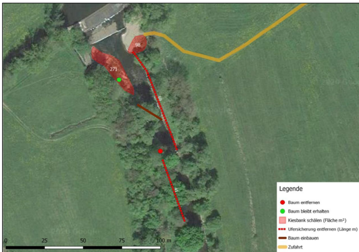
Abb. 8: Geplante Strukturierungsmaßnahmen unterhalb des Wehres Wilhelmshütte.
